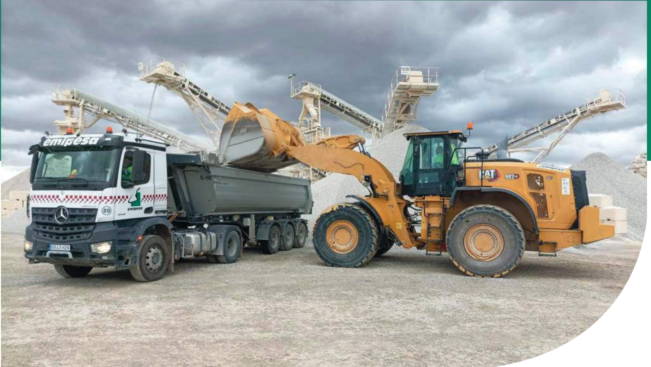
Pala cargadora Cat 982 MXE y bañera en cantera
